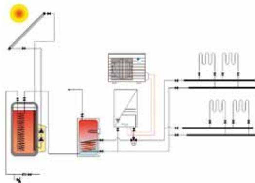
Sistema Daikin Altherma + Energía solar con doble depósito para cumplimiento C.T.E.\*4
